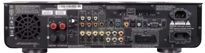
Der Viso Two hat auch zur Integration in Haussteuerungsanlagen entsprechende Anschlüsse zu bieten. Zudem kann über eine spezielle Schnittstelle ein DAB-Empfangsmodul von NAD angeschlossen werden
