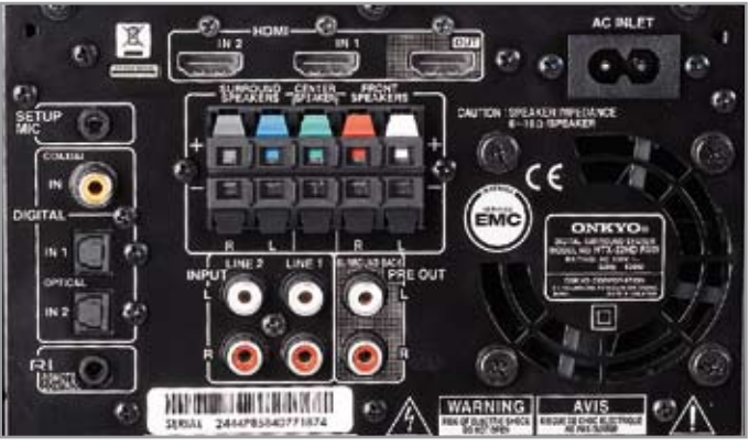
Im Subwoofer sind bereits die Endstufen für den diskreten Ausbau mit Center und Rearlautsprecher vorhanden. Über die analogen Ausgänge lässt sich daraus sogar ein „richtiges“ 7-1-Set machen
